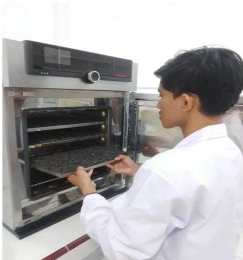
Pengeringan Bottom Ash Menggunakan Oven
