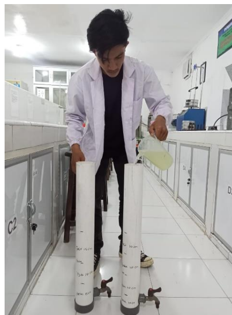
Media Filter Menggunakan Dan Tidak Menggunakan Adsorben Bottom Ash
