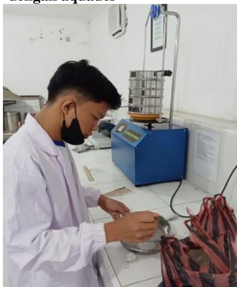
Lampiran D.3. pengayakan fly ash 100 mesh
