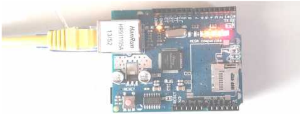
Gambar 4.3 Pengujian Rangkaian Arduino dengan Ethernet Shield W5100
