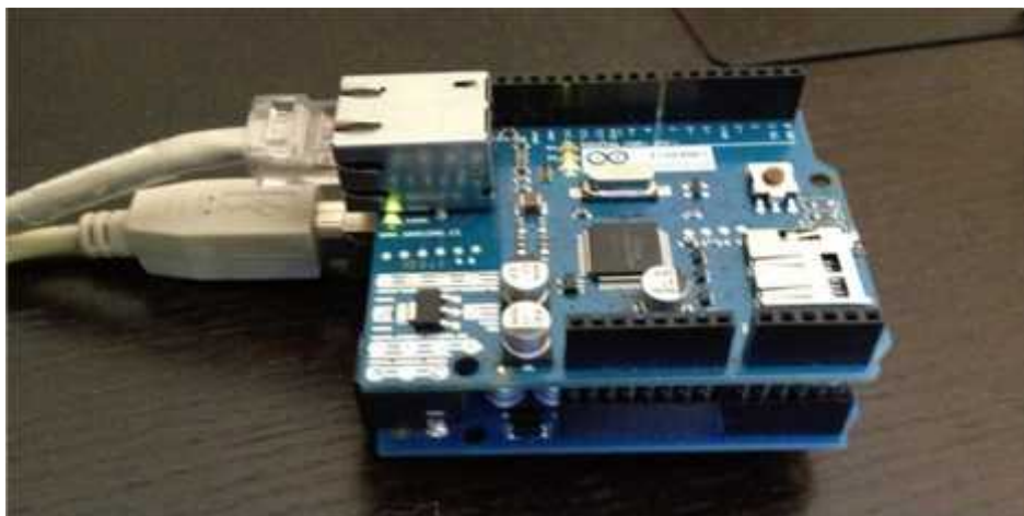
Gambar 4.7 Pemasangan modul ethernet pada modu arduino Uno
