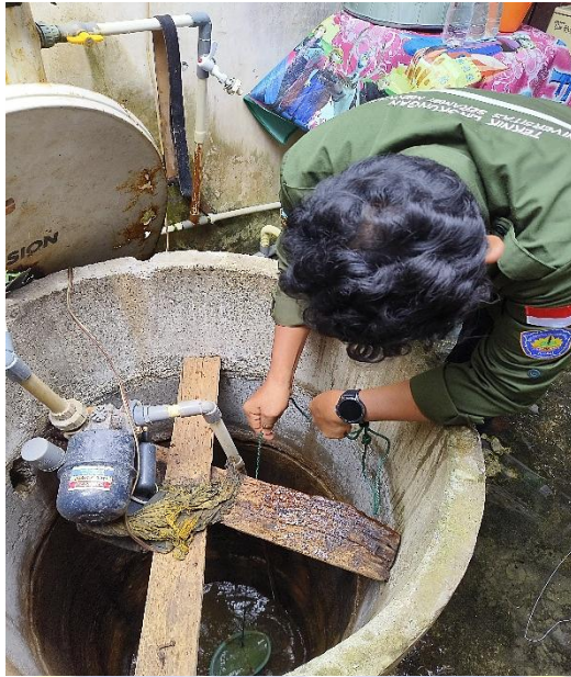
Gambar C.4 Pengambilan Sampel Air Sumur Pada Titik Sampling I
